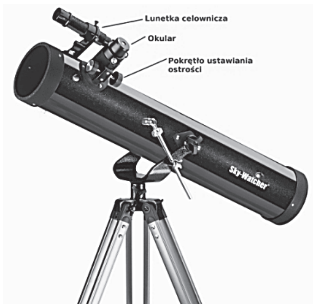
Zdj. 2. Teleskop Sky-Watcher posiadający: układ optyczny Newtona (reflektor), okular, lunetkę celowniczą, pokrętko ustawienia ostrości i statyw
