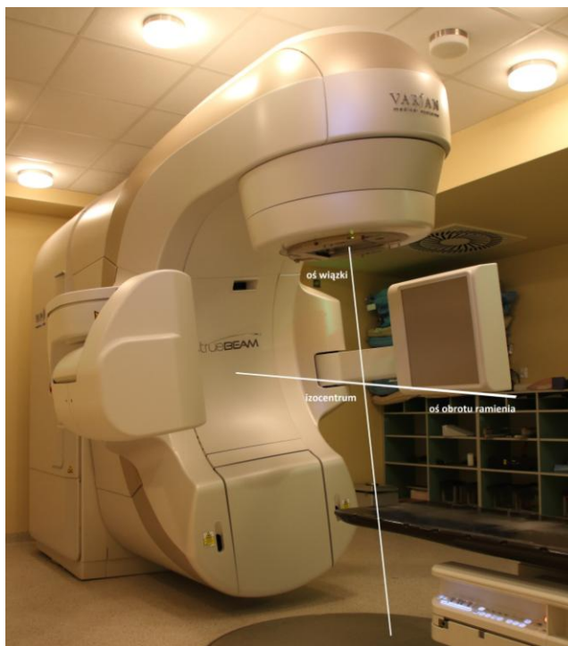
Rys. 1. Akcelerator TrueBeam® z naniesionymi osiami obrotu ramienia oraz wiązki i punkt ich przecięcia – izocentrum aparatu.
